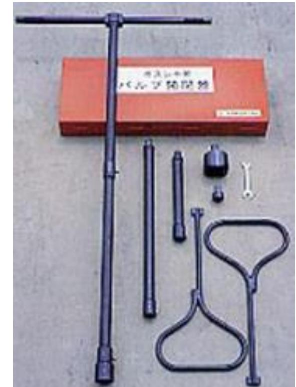
T字型のバルブ開閉器(左)の先にアダプタ(右の棒状のもの)を装着
